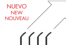
ALETA TIPO 45 Descarga inclinada 45°
