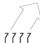
ALETA TIPO 15 Descarga inclinada 15°
